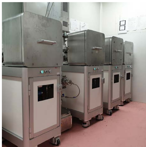
Fig. 4: Réacteur ALD conçu par l'entreprise Surcotec.
