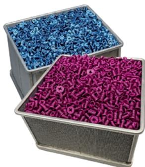
L'innovation **Coolleur** explore l'application de l'ALD pour l'obtention de couleurs en vrac, en mettant en avant les avantages technologiques, la reproductibilité et l'uniformité des couches, ainsi que les propriétés des dépôts d'oxydes de titane réalisés par ce procédé.
